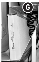
Vaihtopelti kesäasennossa. Vaihtopelti saadaan talviasentoon työntämällä pelti pidikkeen taakse.
