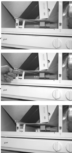
Vaihtopelti kesäasennossa. Vaihtopelti saadaan talviasentoon työntämällä pelti pidikkeen taakse.
